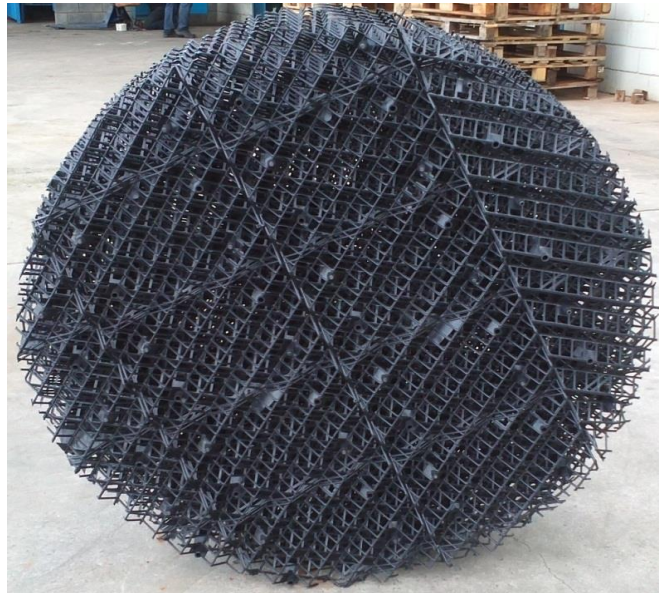
Figura 1. Elemento coalescente empregado nas caixas separadoras água e óleo Bakof Tec.
