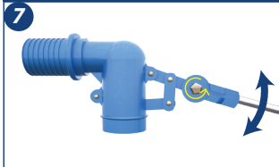
7. Solte o parafuso (amarelo) do centro da cremalheira e ajuste o nível de água do reservatório posicionando para cima ou para baixo a haste da torneira.
